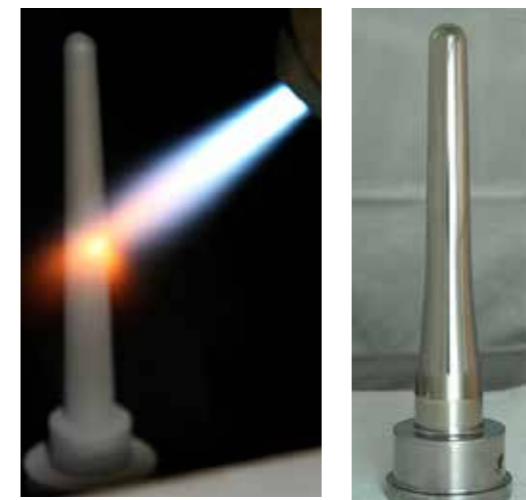
小口冲头采用HVOF喷涂重熔Surfit 53WH
